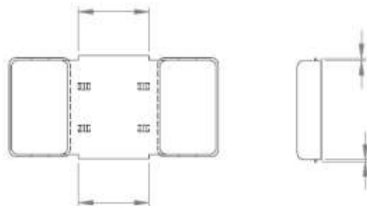
Рисунок 14 – Обозначенные места, предназначенные для прикрепления крышки к трансформатору
