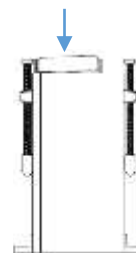
Рисунок 21 – Направление силы, действующей на крышку при монтаже
